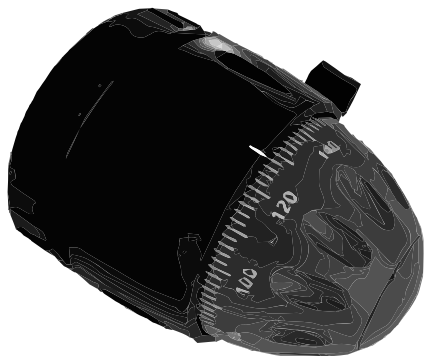
photo du réglage de la vis micrométrique lors de la mise au point sur le 1er trait
