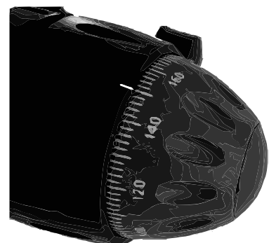
photo du réglage de la vis micrométrique lors de la mise au point sur le 2ème trait
